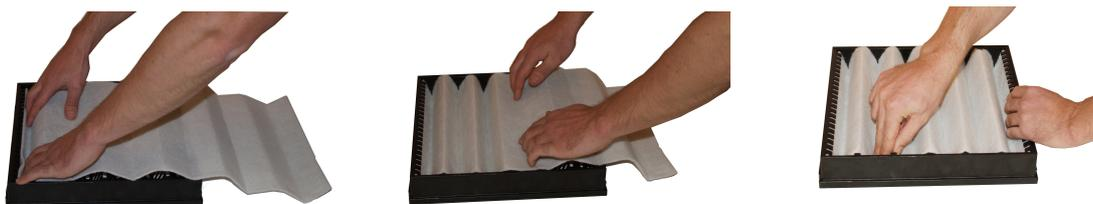
Die „weiche“ Fläche nach außen und die „harte“ Fläche nach innen zum HEPA-Filter drehen.
