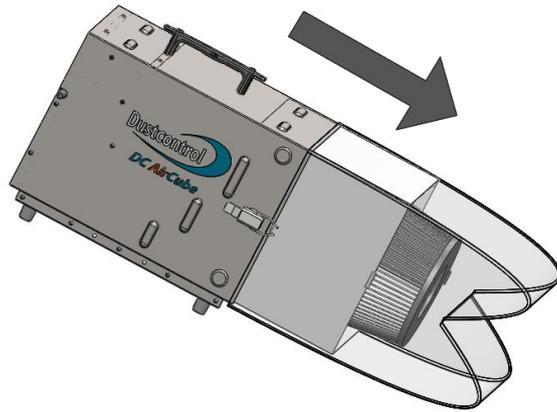
Einbau des HEPA-Filters:
